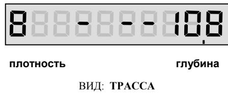
В режиме **ДНО 1М** на экран выводится глубина и информация по распределению объектов только в метровом придонном слое. Этот режим удобен для обнаружения подхода рыбы к прикормке.
